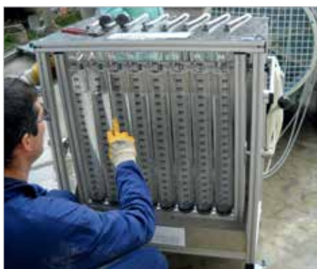
Operazioni di controllo funzionale di un atomizzatore
